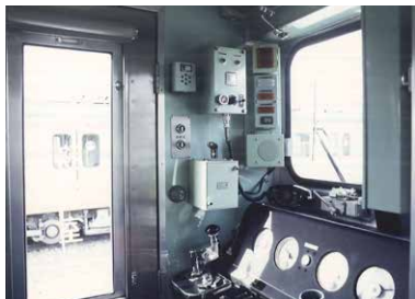
列車誘導無線装置設置（1970年～）
