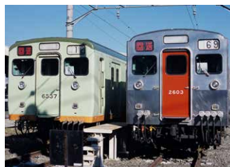
新6000系(左)と2100系(昭和45年登場)。鋼鉄車両とアルミ車両が同時期に製造され、輸送量の増加に対応した
