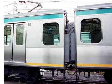
車両連結部の転落防止幌
